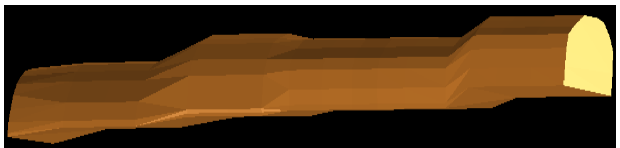
33 Сурет. Көлік штрегінің сканерленген түрі
