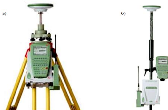
23 Сурет. а) Штативке орнатылған GPS1200 сериялы қабылдағыш; б) вешка орналасқан антенна, далалық ровер және модем
